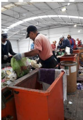
Imagen n°5. Trabajadores/as en cinta transportadora rompiendo las bolsas y separando el material manualmente que posteriormente es depositado en cada tolva. Planta Bella Flor, CEAMSE Norte III. Año 2019.
